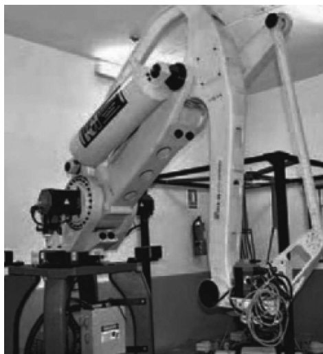
Brazo robótico, tipo paleta, de dos toneladas y 5 metros de radio de acción
